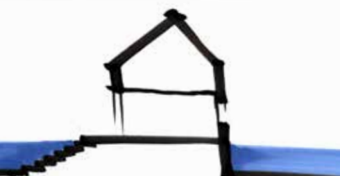
Přesunout obytné místnosti mimo dosah povodně.
