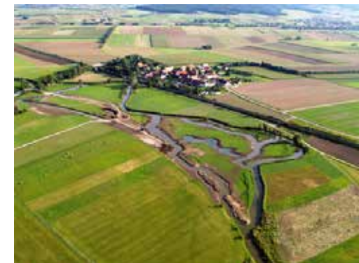
Revitalizace toku řeky v Německu je příkladem přírodně blízkého protipovodňového opatření.
